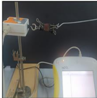
Resim 2.2. Gerilme mukavemet ölçümünde kullanılan cihaz (NOVA500).
